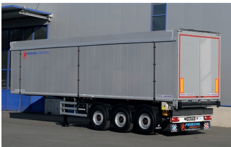
Prvá európska posuvná podlaha s objemom 53 m 3 s vlastnou hmotnosťou menšou ako 6 t! Náves „Baby“ s posuvnou podlahou s hmotnosťou 5 600 kg.
