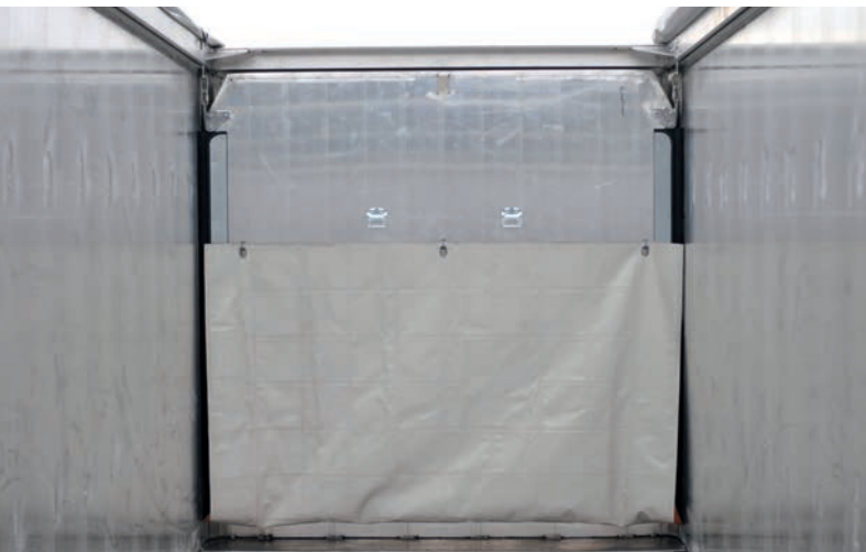
Posúvateľná pohyblivá čelná stena s vlečnou plachtou a špeciálnym čističom koľajničiek.
