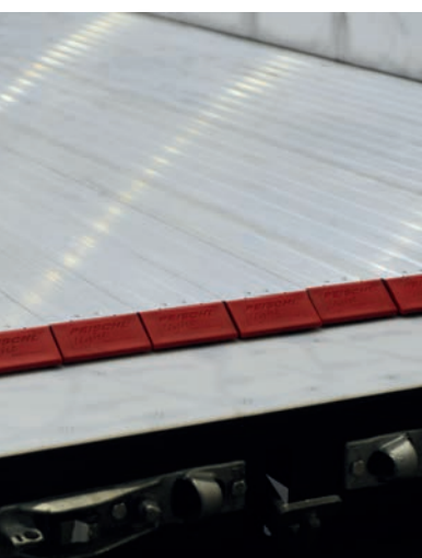
Systém posuvnej podlahy Cargo-Floor, hydraulicky posúvateľná s 21-doskovým systémom na nakladanie a vykladanie.
