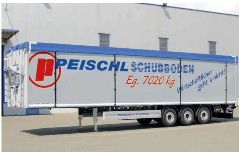
Štandardný náves s posuvnou podlahou. Najľahší svojho druhu na európskom trhu s úžasnými 7 020 kg pri objeme 91 m 3 .
