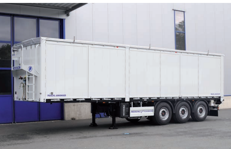
Náves „Baby“ s posuvnou podlahou s bočnými nakladacími dverami po celej dĺžke vozidla. Najľahší svojho druhu na európskom trhu.
