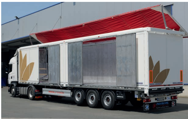
Všestranne vozidlo: kombinácia patentovanej hydraulickej strechy na sypký tovar PEISCHL a prídavných bočných dverí po celej dĺžke bočnej strany.
