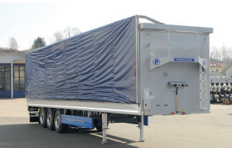
Patentovaná hydraulická strecha na sypký tovar (najmä štiepku) PEISCHL vl. hmotnosť 7 690 kg.
