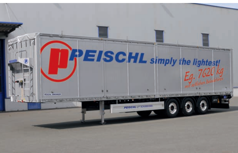
Náves s posuvnou podlahou s bočnými nakladacími dverami po celej dĺžke vozidla. Najľahší svojho druhu na európskom trhu s úžasnými 7 620 kg pri objeme 91 m 3 .
