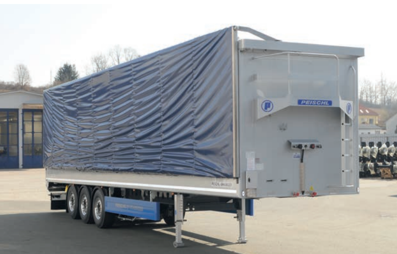
Patentovaná hydraulická strecha na sypký tovar (najmä štiepka) PEISCHL vl. hmotnosť 7 690 kg.
